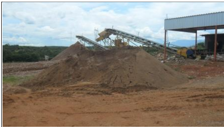
Foto 23: Areia proveniente do processo de reciclagem de material da construção civil
